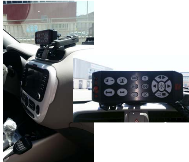
Cuadro de mandos y detalle del mando del puente
