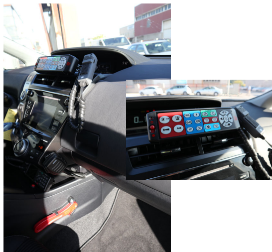
Cuadro de mandos y detalle del mando del puente
