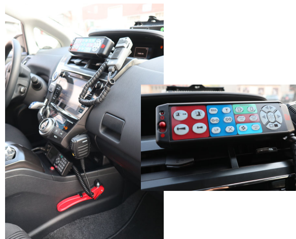
Cuadro de mandos y detalle del mando del puente
