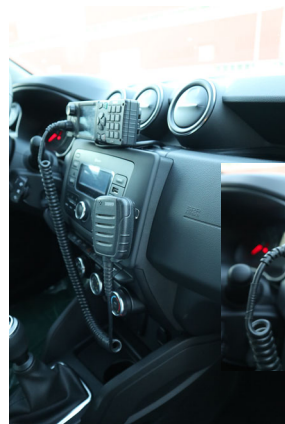
Quadre de comandaments i detall de la emissor TETRA
